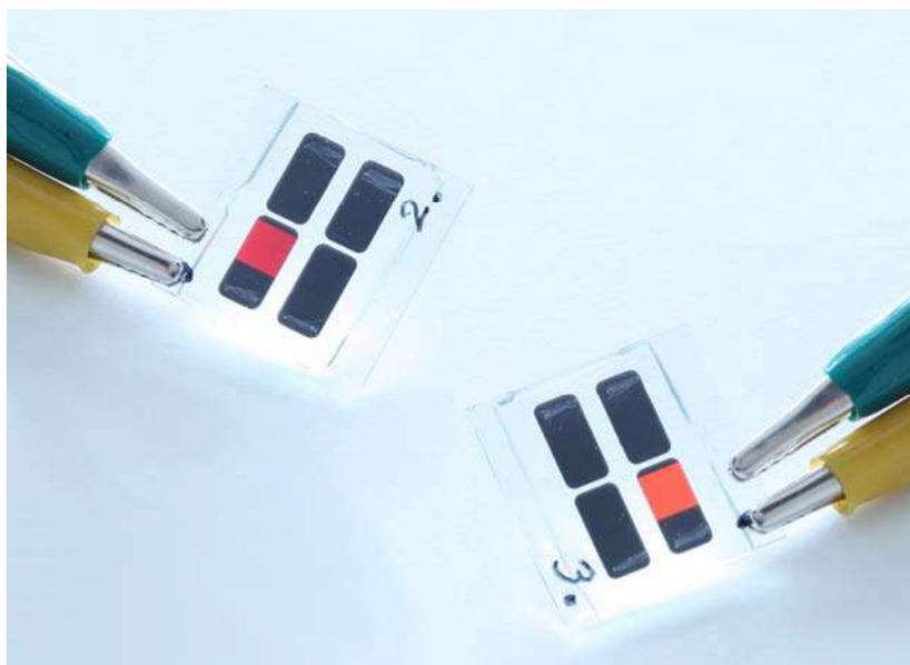
*Flüssigprozessierte SiLEDs: Die Änderung der Größe der Silizium-Nanokristalle ermöglicht es, die Farbe des ausgesandten Lichts zu variieren. (Abbildung: F. Maier-Flaig, KIT/LTI)*
